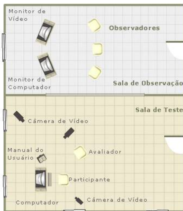
Fig 5: Configuração de uma sala de testes (Testes de usabilidade - Kátia Gomes Ferreira)
